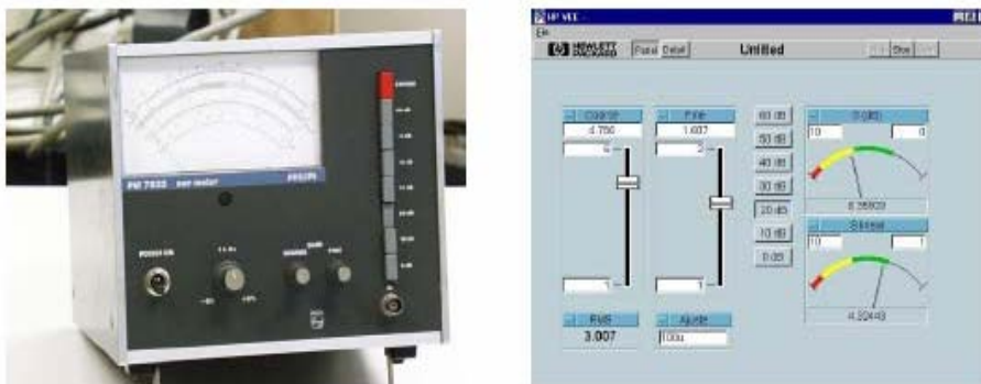
Slika 4. Klasični i virtuelni instrument
