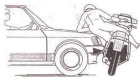
Slika br. 6. Sudarni položaj prednjeg branika putničkog automobila i bočnog ojačanja na motociklu radi zaštite vozačevih nogu
