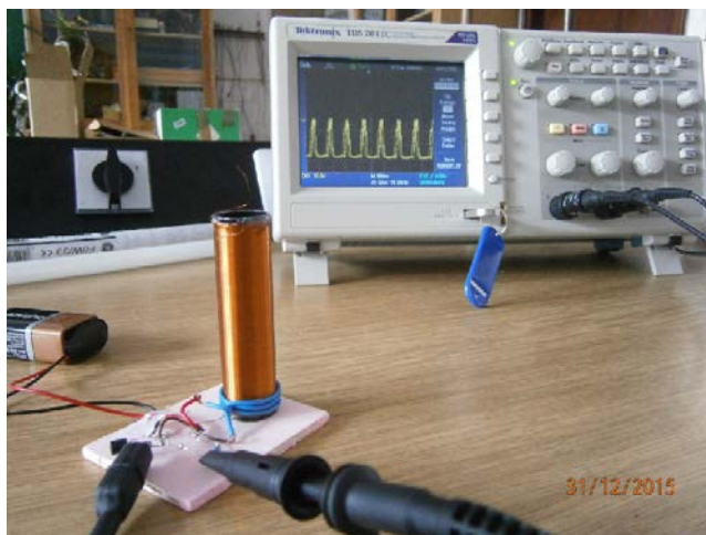
Slika 4. Prikaz frekvencije oscilovanja malog Teslinog kalema na osciloskopu
