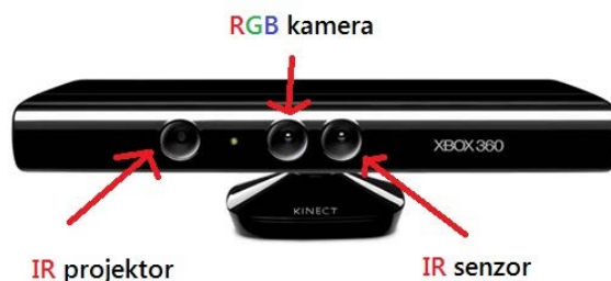
Slika 1. Lokacije IR projektora i senzora na Kinect-u
